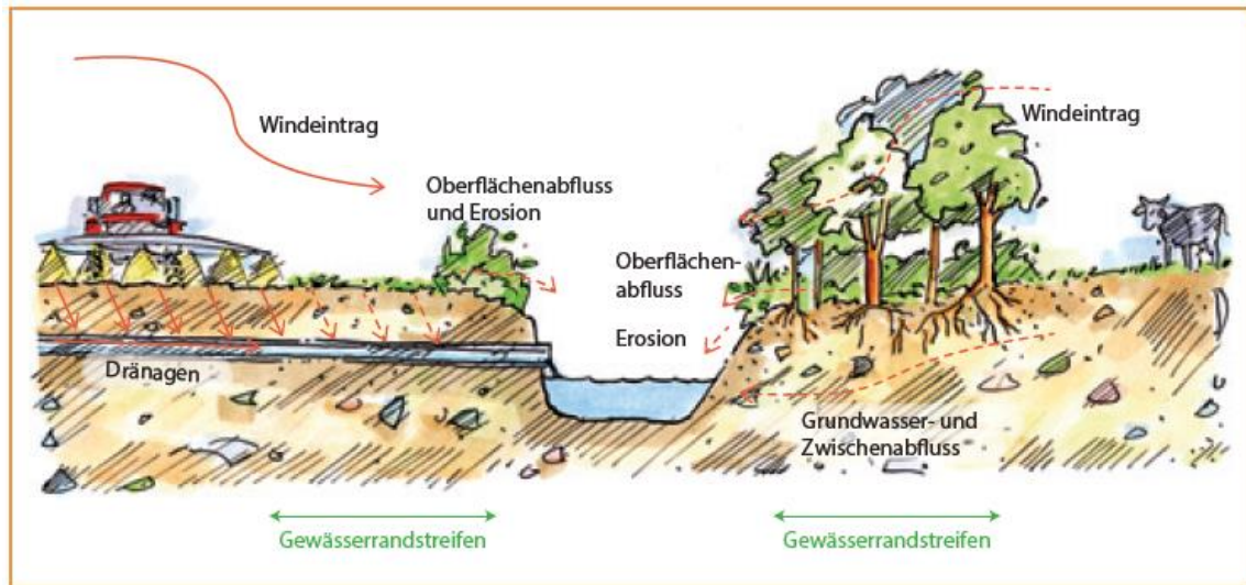
Abbildung 8: Reduktion der Stoffeinträge aus der Fläche durch Gewässerrandstreifen im Außenbereich [4]
